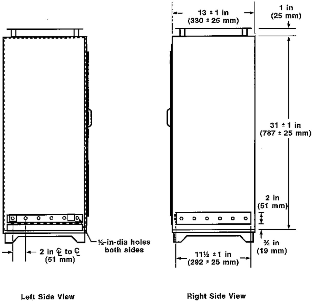
FIGURE B-3. SIDE VIEWS OF BUNSEN BURNER TEST CABINET
