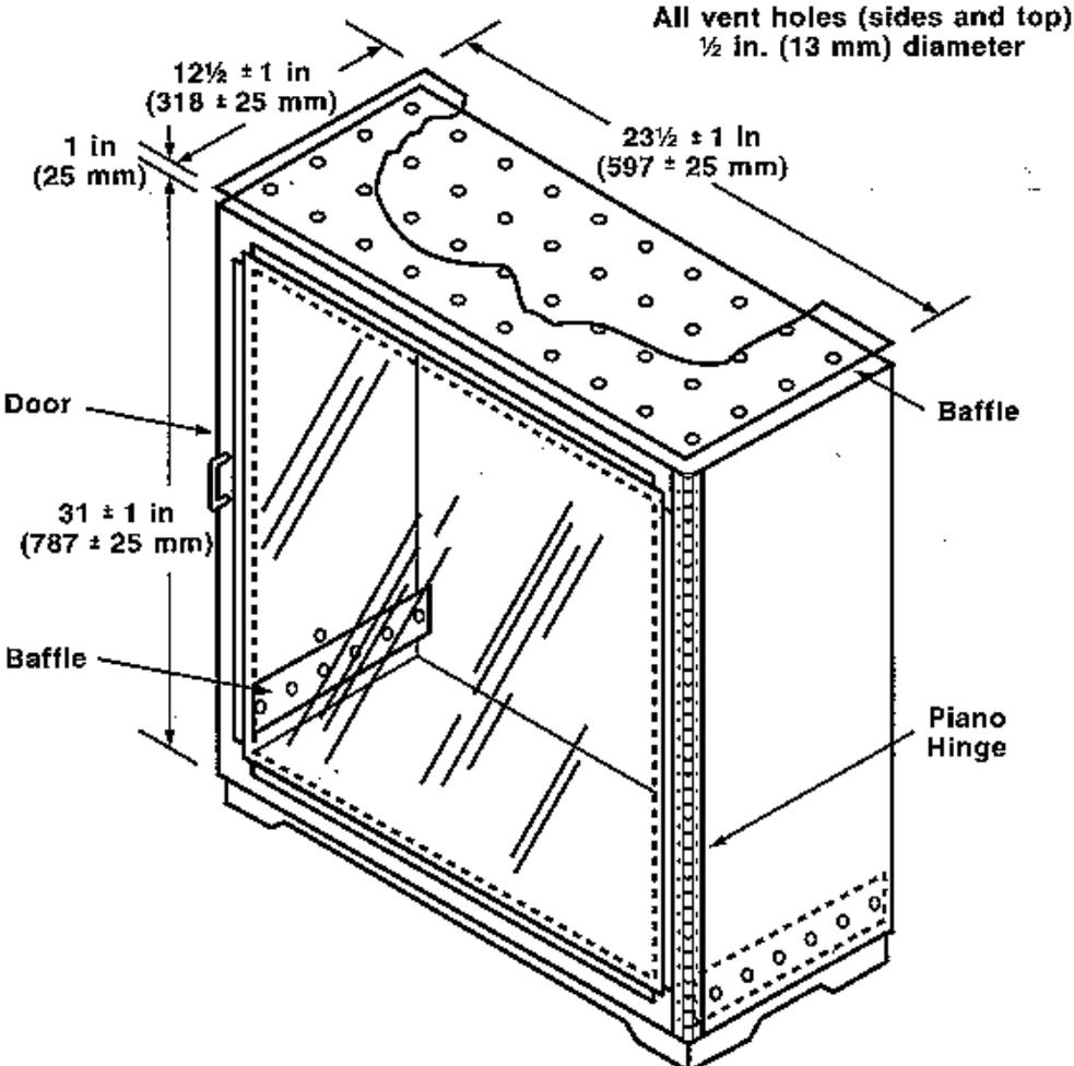
FIGURE B-1. SKETCH OF BUNSEN BURNER TEST CABINET
